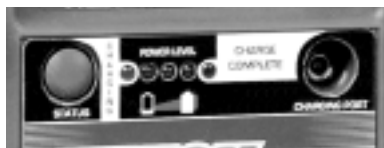
Gráfico 2. Botón de prueba, indicadores LED de carga en curso y unidad cargada
